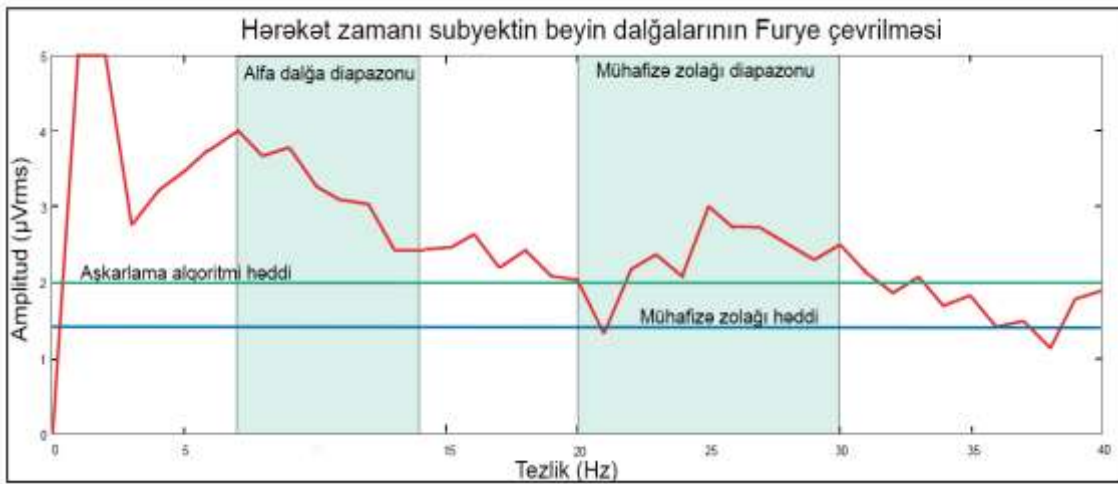
Şəkil 4. Rahat olmayan vəziyyətdə hərəkət edən subyektin nümunə spektri
