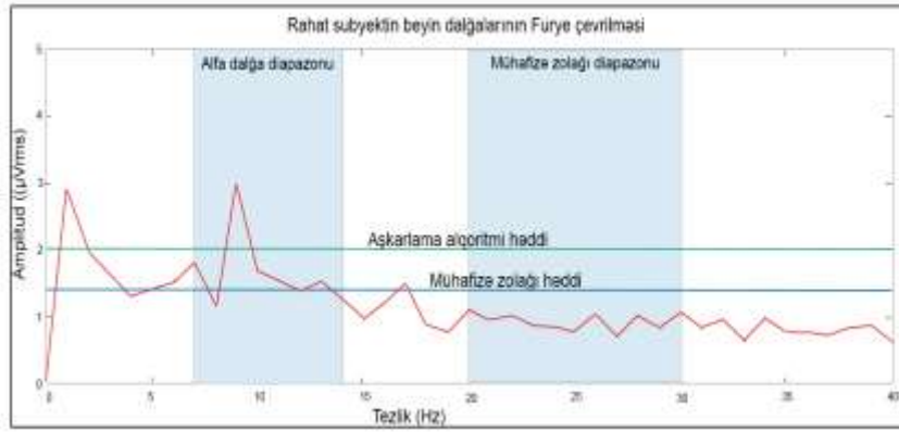
Şəkil 3. Rahat vəziyyətdə olan subyektin nümunə spektri 7 və 14 Hz arasında olan tezliklərdən birinin amplitud, aşkarlama alqoritmi
