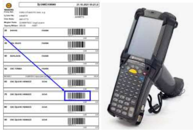
Şekil 2.1: İş emri ile el terminalinin barkod okuyucu ile eşleştirilmesi
