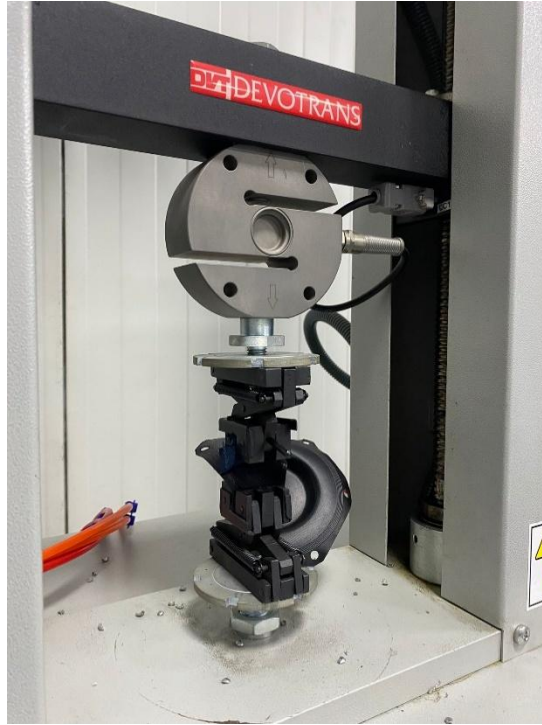
Şekil 2. Kort Bezli Diyaframların Çekme Kopma Mukavemet Testleri
